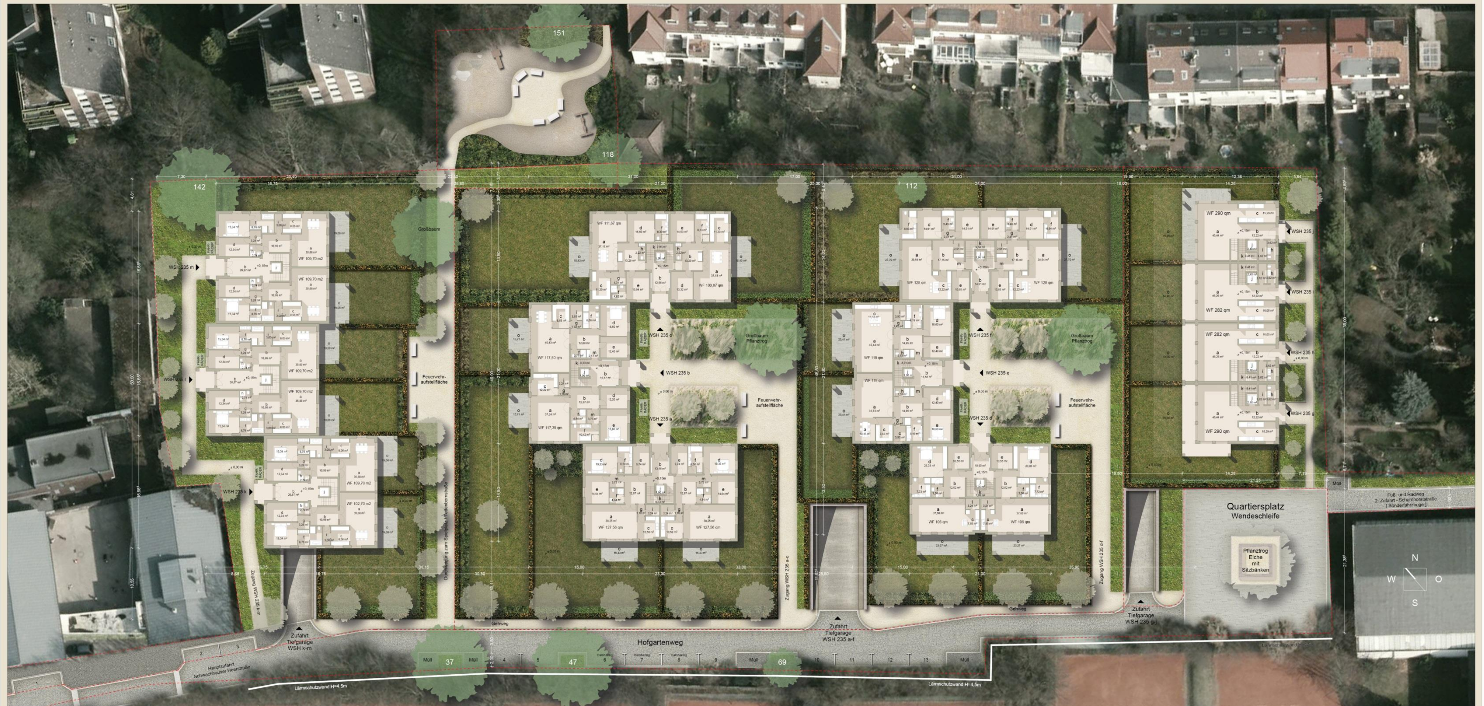
WOHNPAK SCHWACHHAUSER HEERSTRASSE GRUNDRISS ERDGESOSSE IM LAGEPLAN M 1 : 200 | Legende: a Wohnen b Entree c Küche d Schlafen e Kind / Zimmer f Bad g Flur h WC i Hauswirtschaftsraum j Lift k Treppe l Abstellraum m Garderobe n Balkon o Terrasse
