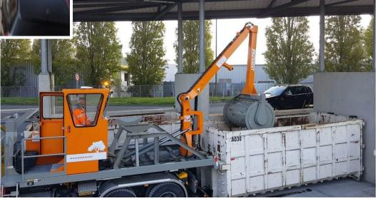
Verdichtung der Containerinhalte vor Ort durch Rollpacker, um geringe Füllmengen zu vermeiden.
